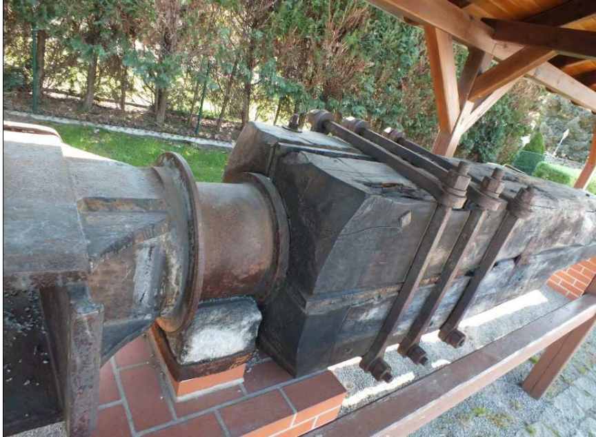
Die Flügelwelle aus dem Jahr 1881 besteht aus vier mächtigen Holzteilen
