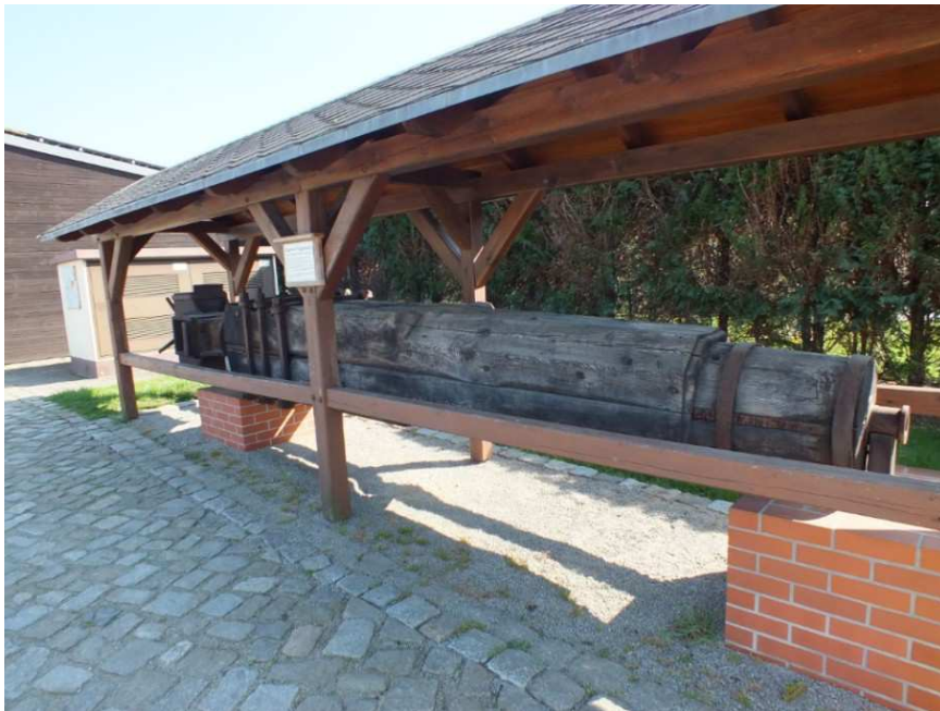
Die Flügelwelle aus dem Jahr 1881 besteht aus vier mächtigen Holzteilen
